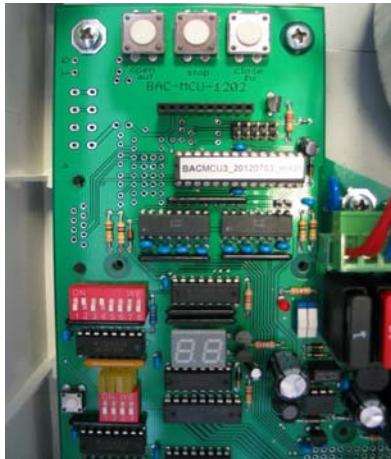
Bild: Programmier Tasten auf der Platine
